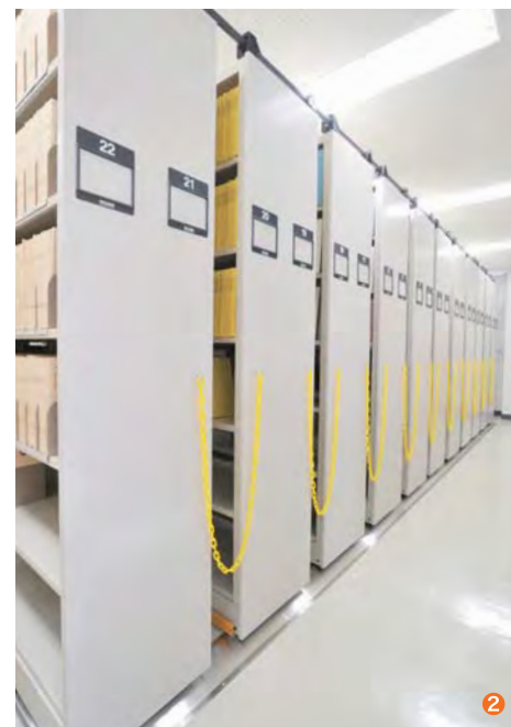
電動書架の背面 誤って書架通路内に進入しないように チェーンをつけています。
