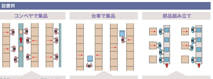
集品用ケースをコンベヤで搬送しながら ピッキング。HPD表示器を使ったシステム を導入することにより、作業効率を更に アップすることができます。
